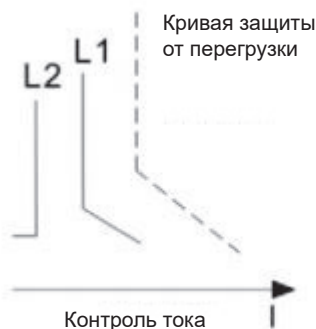
Рабочие характеристики контроля нагрузки по току
